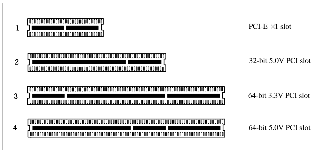
图2 PCI及PCI-E插槽
