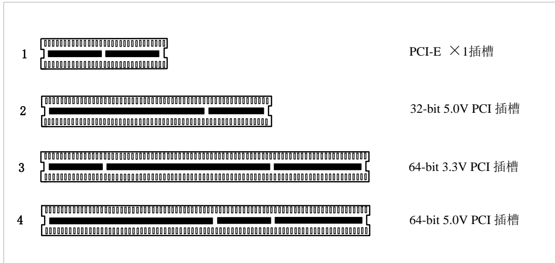
图4 PCI-E和PCI插槽
